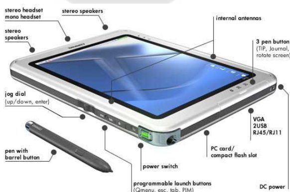
ภาพประกอบ 16 รูปแบบโครงสร้างภายนอกของแท็บเล็ตคอมพิวเตอร์ ( Tablet ) ทั่วไป
