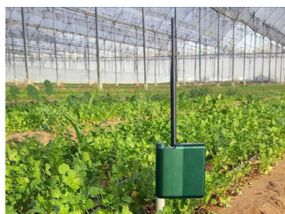
ภาพประกอบ 4 เซนเซอร์วัดความชื้น และแร่ธาตุในดิน
