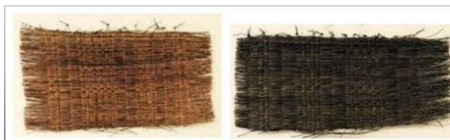
ภาพประกอบ 19 กระบวนการขึ้นรูปด้วยการทอด้วยเส้นก้านกาบตาลทั้งเส้นยืนและเส้นพุ่ง
