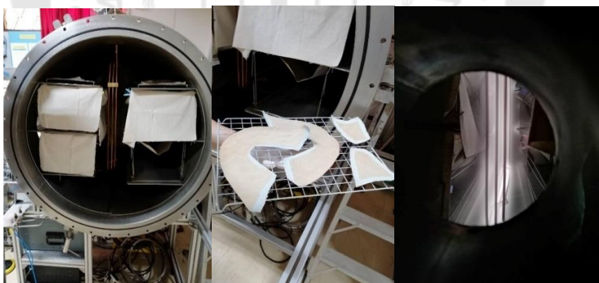
ภาพประกอบ 66 เครื่องปฏิกรณ์พลาสมาความถี่วิทยุแรงดันต่ำขนาดใหญ่ ของศูนย์วิจัยฟิสิกส์ของพลาสมาและลำอนุภาค(ซ้าย) การติดตั้งชิ้นงานเพื่ออบพลาสมา(กลาง) และภาพขณะอบพลาสมา(ขวา)
