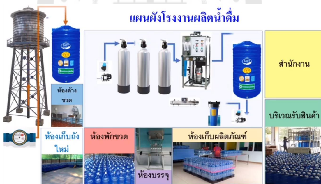
ภาพประกอบ 1 แผนผังโรงงานผลิตน้ำดื่ม
