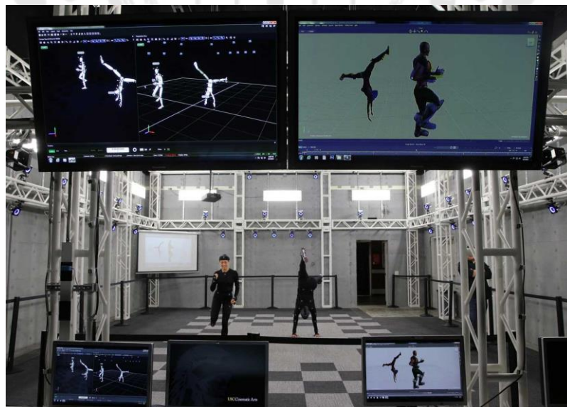
ภาพประกอบ 55 ภาพแสดงรูปแบบการติดตั้งกล้อง Mocap แบบ Optical ที่มา : https://optitrack.com/
