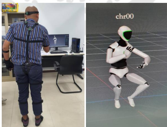
ภาพประกอบ 47 ภาพการทำการทดสอบชุด Perception Neuron โดยผู้บกพร่องทางการได้ยิน และภาพหน้าจอที่แสดงผลการเคลื่อนไหวแบบ Realtime
