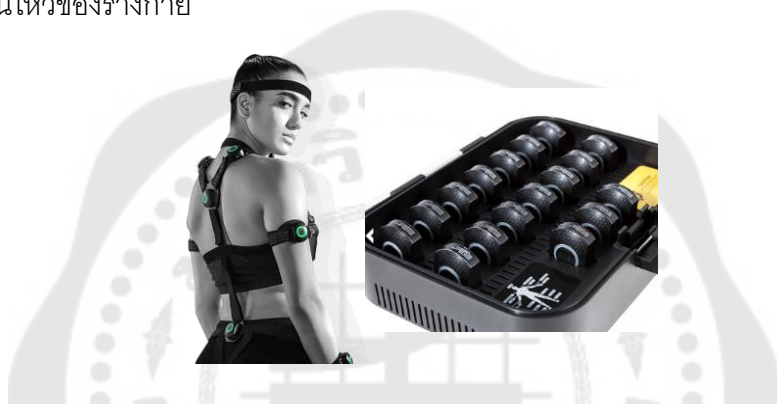
ภาพประกอบ 46 อุปกรณ์เซ็นเซอร์ Perception Neuron ติดตามตัวของนักแสดงโดยใช้สายรัดตามบริเวณต่างๆ
