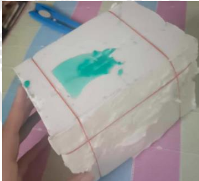
เทหล่อเรซินลงในแม่แบบมาสดกด
