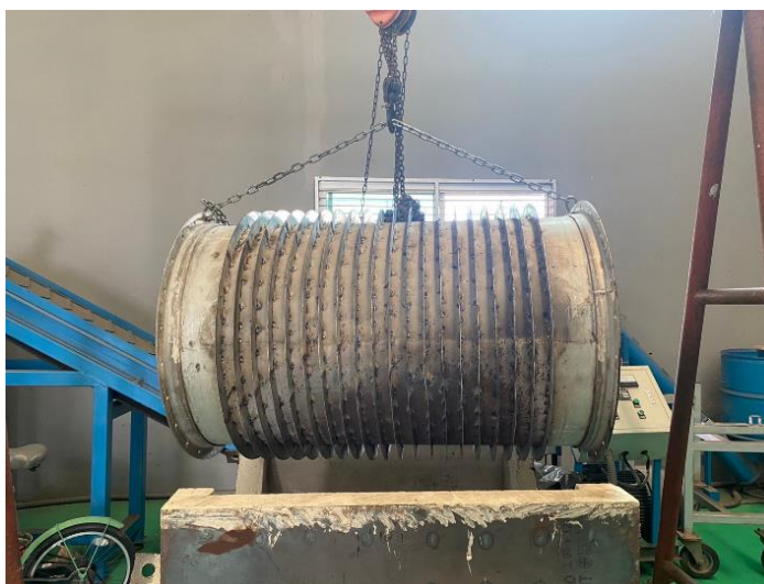
ภาพประกอบ 15 ครีบน้ำร้อนบริเวณผิวด้านนอกเตาเผาถ่าน
