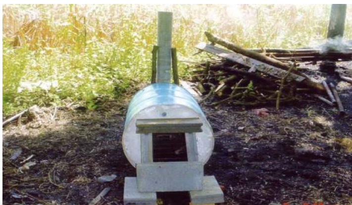
ภาพประกอบ 10 เตาถังน้ำมัน 200 ลิตร แบบเตาถังเดี่ยวแบบนอน
