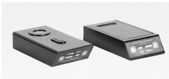
ภาพประกอบ 19 เครื่องวัดปริมาณออกซิเจนในกล้ามเนื้อ
