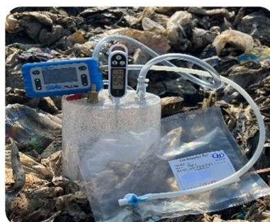
ภาพประกอบ 14 การเก็บตัวอย่างสารอินทรีย์ระเหยง่ายด้วยวิธี Surface emission isolation fluxes chamber ต่อเข้ากับปั๊มสุญญากาศ และดึงอากาศผ่านถุงเก็บตัวอย่างอากาศชนิดเทดลาร์
