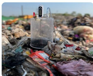
ภาพประกอบ 14 การเก็บตัวอย่างสารอินทรีย์ระเหยง่ายด้วยวิธี Surface emission isolation fluxes chamber ต่อเข้ากับปั๊มสุญญากาศ และดึงอากาศผ่านถุงเก็บตัวอย่างอากาศชนิดเทดลาร์
