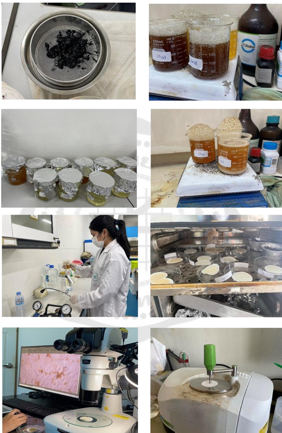
ภาพประกอบ 35 การวิเคราะห์สัณฐานวิทยาของ MPs ด้วยกล้องสตอริโอไมโครสโคป และ เครื่อง
