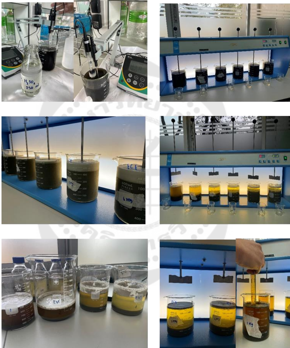
ภาพประกอบ 37 วิเคราะห์หาชนิดและปริมาณสารตกตะกอน ด้วยเครื่อง Jar test
