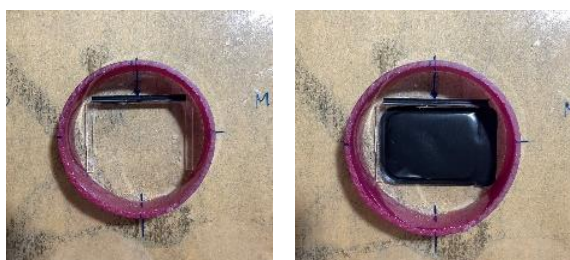
ภาพประกอบ 5 ภาพซ้าย แสดงแผ่นแบบอะคริลิกที่ประดิษฐ์ขึ้นมา ภาพขวา แสดงการวางฟิล์มขนาด 2 ในแท่นแบบในตำแหน่งกึ่งกลางโดยไม่มีกรวยขยับ
