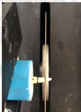
ภาพประกอบ 9 การตัดฟันด้วยเครื่องตัดความเร็วต่ำ
