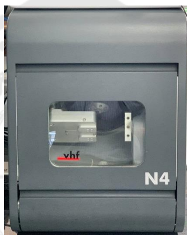
ภาพประกอบ 9 เครื่องกลึงมาสเตอร์มิลล์ เอ็นไฟว์ ใช้กลึงชิ้นทดสอบลิเทียมไดซลิเกต
