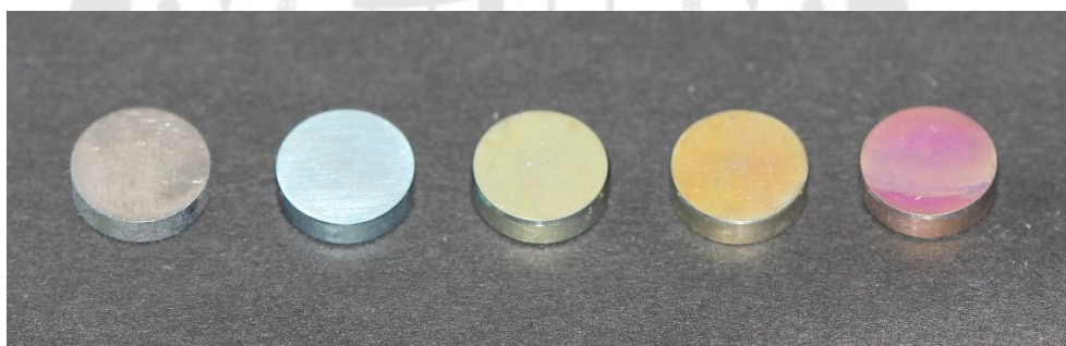
ภาพประกอบ 4 ตัวอย่างชิ้นทดสอบไทเทเนียมและไทเทเนียมที่ผ่านกระบวนการอะโนไดซ์ที่ความเข้ม 40, 50, 60 และ 70 โวลต์(ซ้ายไปขวา)
