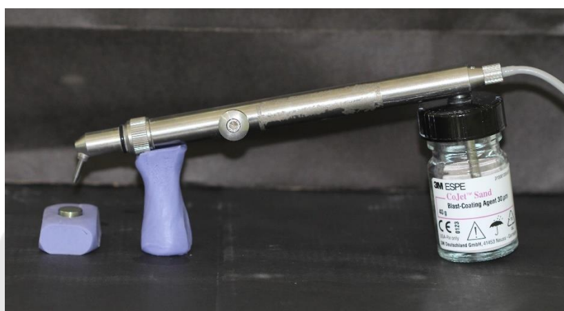
ภาพประกอบ 7 การปรับปรุงผิวไทเทเนียมด้วยวิธีการไตรโบเคมีคอล ซิลิกาโค้ทติ้ง
