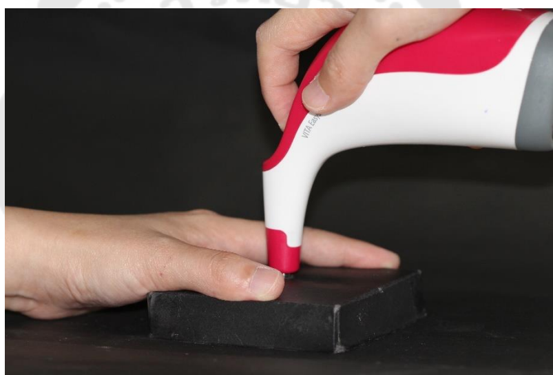
ภาพประกอบ 15 แสดงการวัดสีขึ้นทดสอบด้วยเครื่องสเปกโทรโฟโตมิเตอร์
