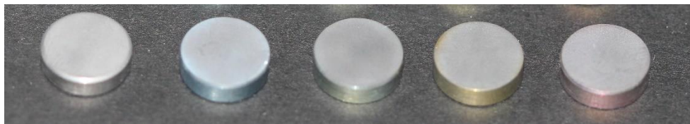
ภาพประกอบ 6 ตัวอย่างชิ้นทดสอบไทเทเนียมและไทเทเนียมที่ผ่านกระบวนการอะโนไดซ์ที่ความเข้ม 40, 50, 60 และ 70 โวลต์ผ่านการปรับปรุงผิวด้วยวิธีการไตรโบเคมีคอล ซิลิกาโค้ทติ้ง(ซ้ายไปขวา)
