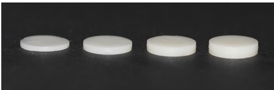
ภาพประกอบ 8 ตัวอย่างชิ้นทดสอบเซรามิกกลุ่มลิเทียมไดซลิเกตความหนา 1.0, 1.5, 2.0 และ 2.5 มิลลิเมตร(ซ้ายไปขวา)
