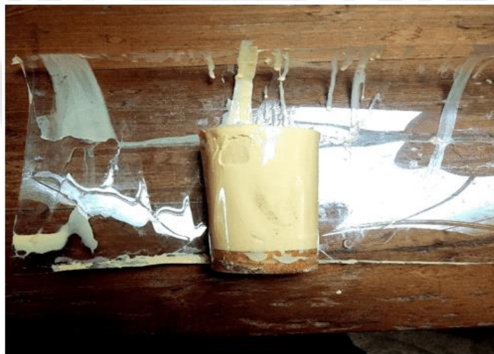
ภาพประกอบ 45 เรซินส่วนกระบอกที่แกะออกจากพิมพ์แล้ว
