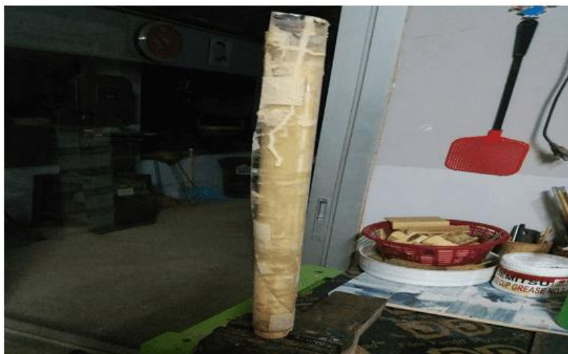
ภาพประกอบ 41 เทเรซินลงในพิมพ์สำหรับหล่อเป็นคันทวนสอดด้วง
