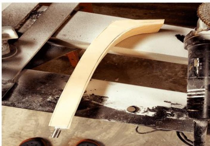
ภาพประกอบ 50 ครูจ๊กกรี้ มงคล วัดขนาดและวาดแบบลงบนท่อนเรซินส่วนทวนบน
