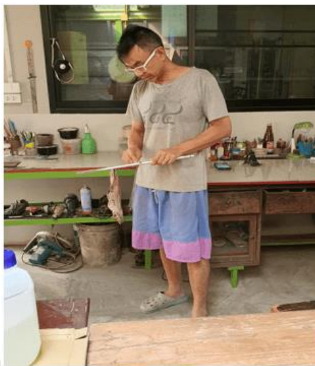
ภาพประกอบ 19 ครูจักรี มงคล นำท่ออะลูมิเนียมมาทาบเพื่อทำเป็นพายสำหรับกวมเรซิน
