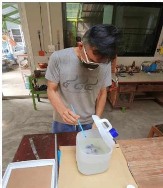
ภาพประกอบ 22 ครูจักรี มงคลเพิ่มปริมาณตัวม่วงเพื่อผสมเรซินให้ได้สีชมพูจางตามที่ต้องการ
