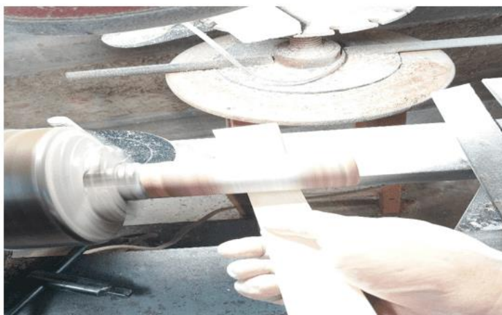
ภาพประกอบ 51 ครูจักรี มงคลสิงทวนบนสอดด้วงตามแบบที่วาดไว้
