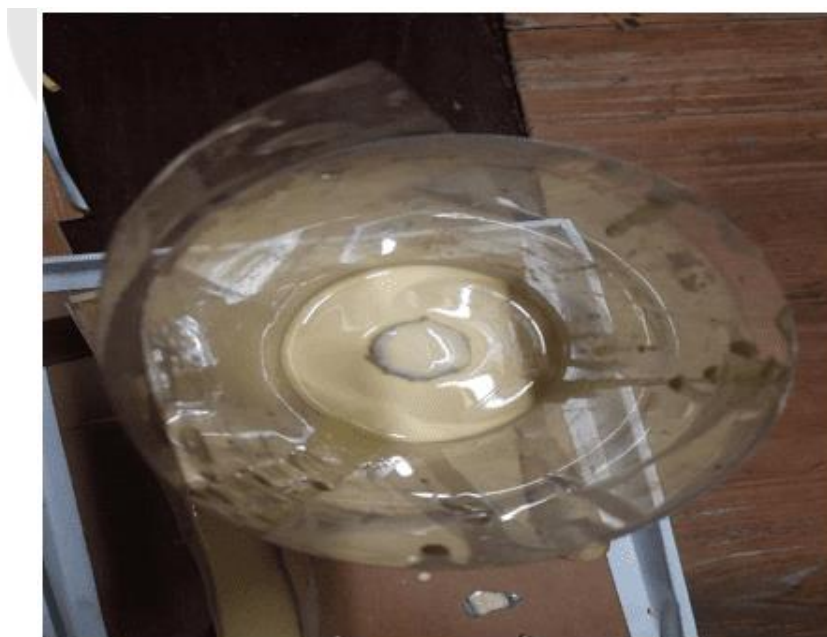
ภาพประกอบ 42 เรซินขณะอยู่ในพิมพ์สำหรับหล่อเป็นกระบอกลอดด้วง
