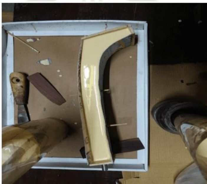
ภาพประกอบ 40 เทเรซินลงในพิมพ์สำหรับหล่อเป็นส่วนชิ้นซอด้าง
