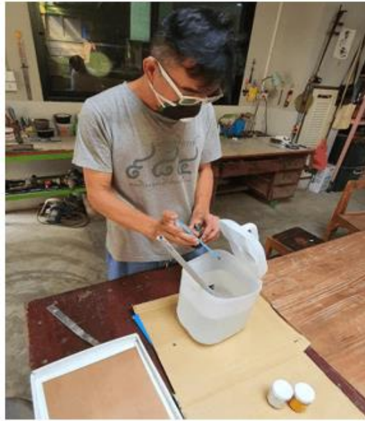
ภาพประกอบ 20 ครูจ๊กกี้ มงคล กำลังผสมตัวม่วงลงไปในเรซินที่ละเล็กลง
