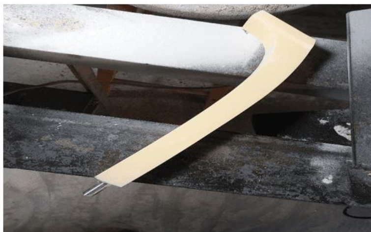
ภาพประกอบ 53 ทวนบนซอด้วงที่กลึงเรียบร้อยแล้ว
