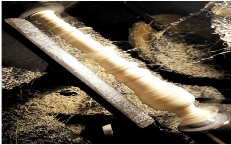
ภาพประกอบ 63 เรซินที่นำมากลึงขึ้นรูปเป็นลูกบิดซอด้วง 1
