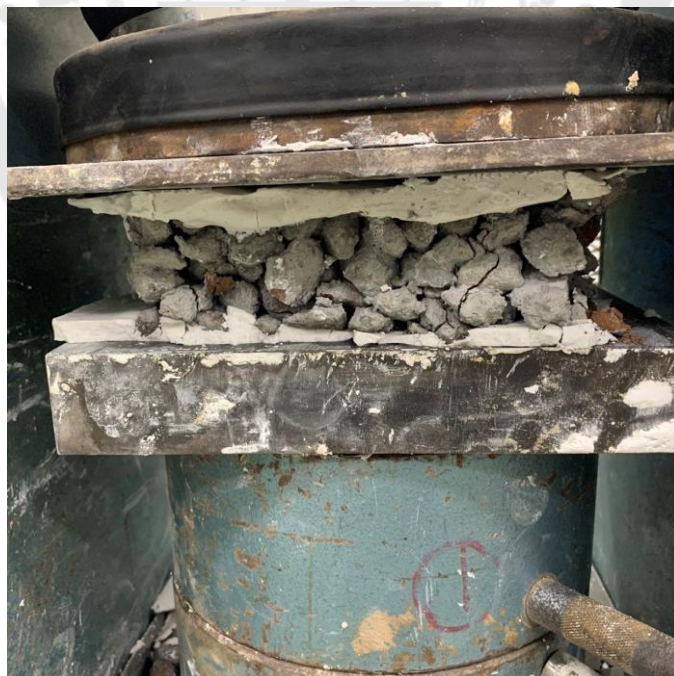
ภาพประกอบ 70 การทดสอบความสามารถรับแรงอัดของบล็อกซีเมนต์น้ำหลังปรับแก้สมบัติ
