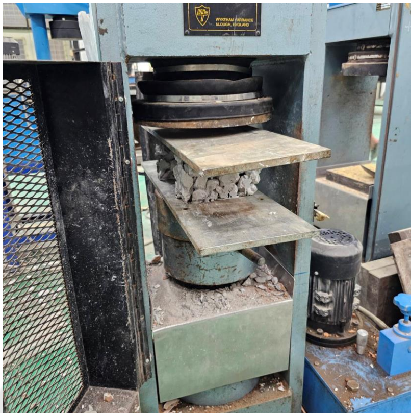
ภาพประกอบ 64 การทดสอบความสามารถการรับแรงอัดของบล็อกซีเมนต์น้ำ
