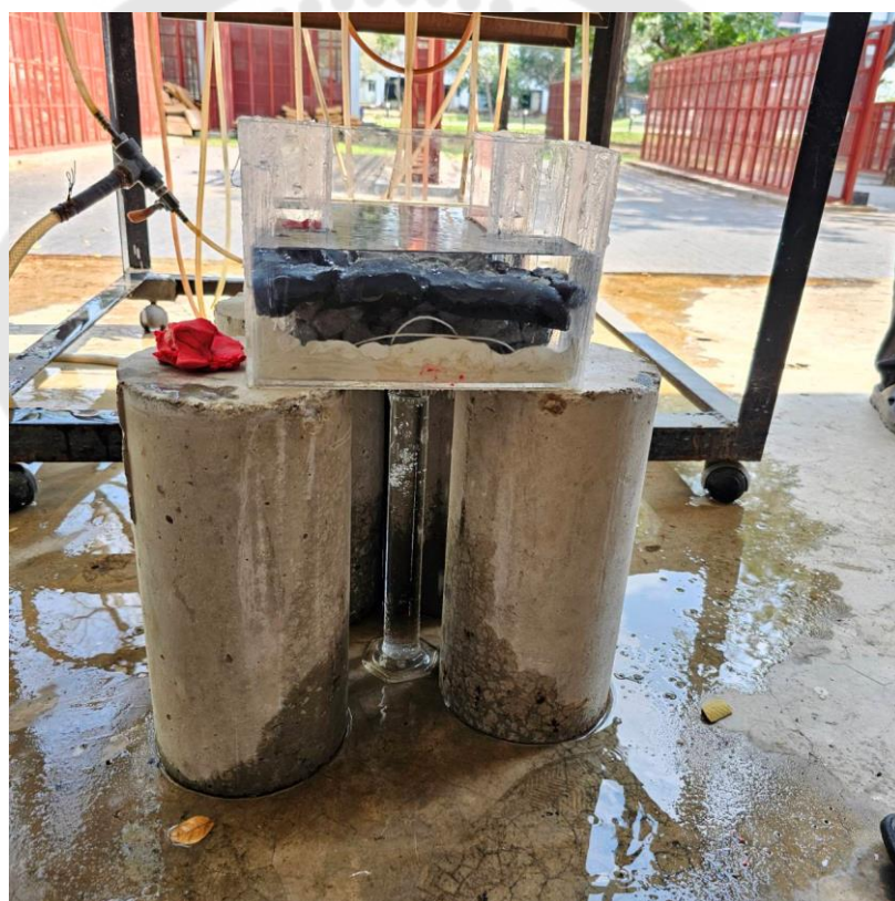
ภาพประกอบ 63 การทดสอบการซึมผ่านของน้ำของบล็อกซีเมนต์น้ำ
