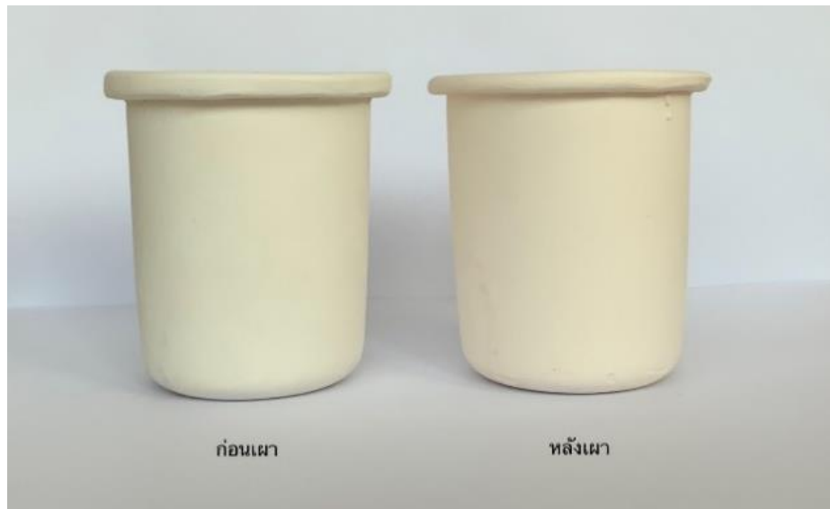
ภาพประกอบ 45 ตัวอย่างเปรียบเทียบผลิตภัณฑ์เซรามิกก่อนและหลังเผาโดยใช้เตาเผาแบบไฟฟ้า
