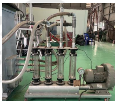
ภาพประกอบ 22 พัดลมป้อนอากาศ (Air fan part)
