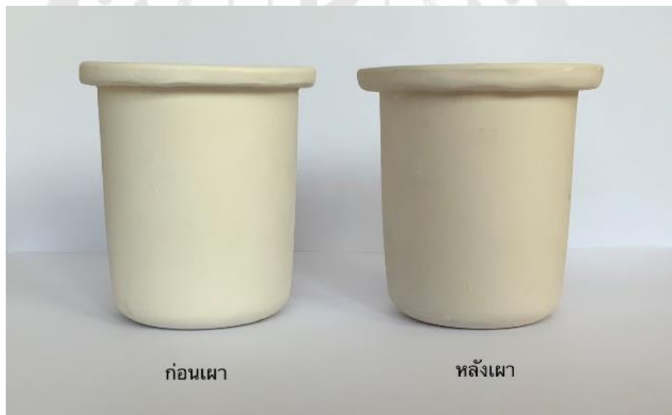
ภาพประกอบ 46 ตัวอย่างเปรียบเทียบผลิตภัณฑ์เซรามิกก่อนและหลังเผาโดยใช้เตาจากชุดการ ทดลอง
