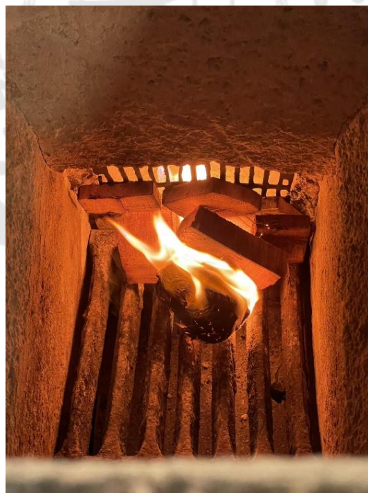
จุดเตาผลิตและเผาไหม้แก๊สเชื้อเพลิงสังเคราะห์
