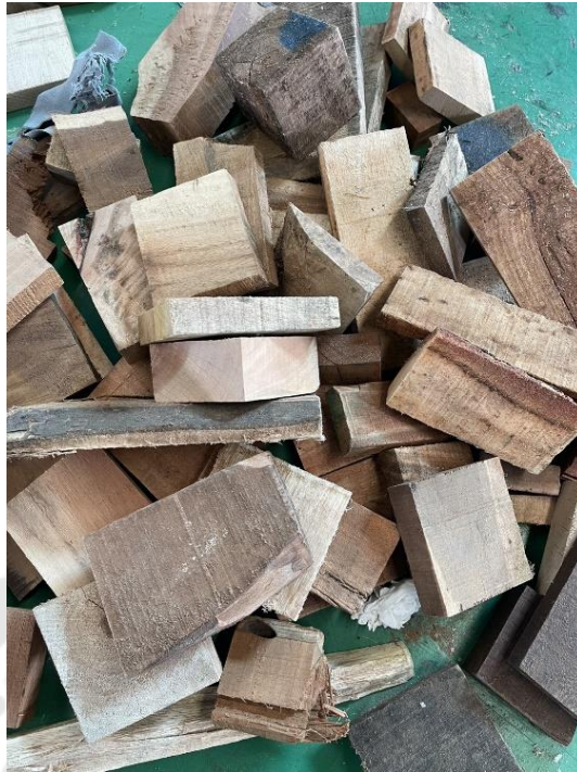
ตัวอย่างไม้ยางพาราที่ใช้เป็นเชื้อเพลิงสำหรับการทดลอง
