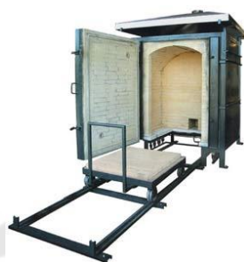
ภาพประกอบ 6 เตารถเข็นหรือเตาชัตเติล (Car kilns or Shuttle Kiln)
