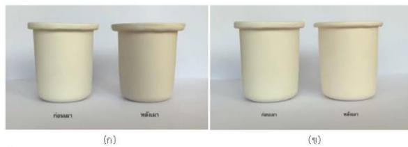
ภาพที่ 5 แสดงตัวอย่างผลิตภัณฑ์เซรามิกก่อนและหลังเผา (ก) จากชุดการทดลอง (ข) เตาไฟฟ้า
