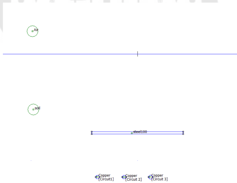
ภาพประกอบ 21 ตัวอย่างการจำลองซีลด์ steel100 เมื่อจัดวางสายส่งแบบ best case ในโปรแกรม Finite Element Method Magnetics (FEMM)
