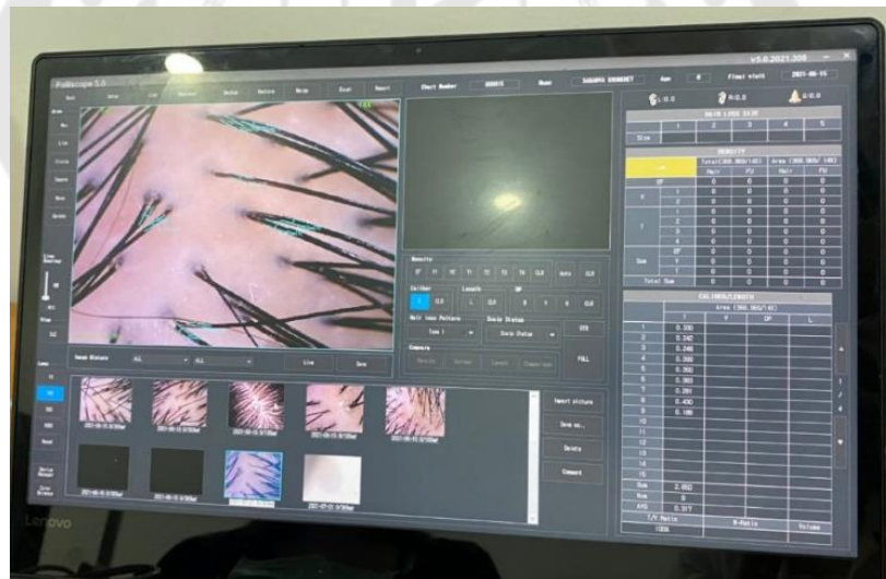
ภาพประกอบ 11 แสดงการวัดค่า hair diameter ผ่านระบบคอมพิวเตอร์
