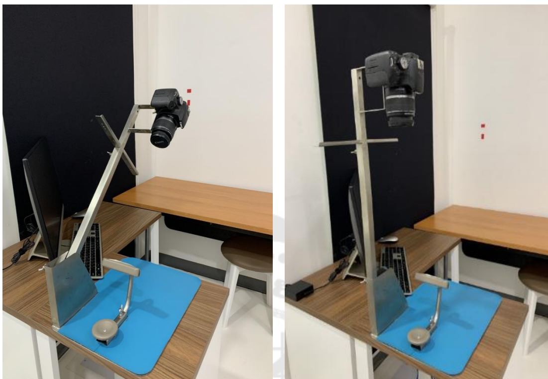
ภาพประกอบ 12 และ 13 แสดงเครื่องมือ stereotactic device พร้อมเครื่องกล้องถ่ายรูป ไว้ที่มุมมอง 45 องศา (frontal view) และที่มุมมอง 90 องศา (vertex view)
