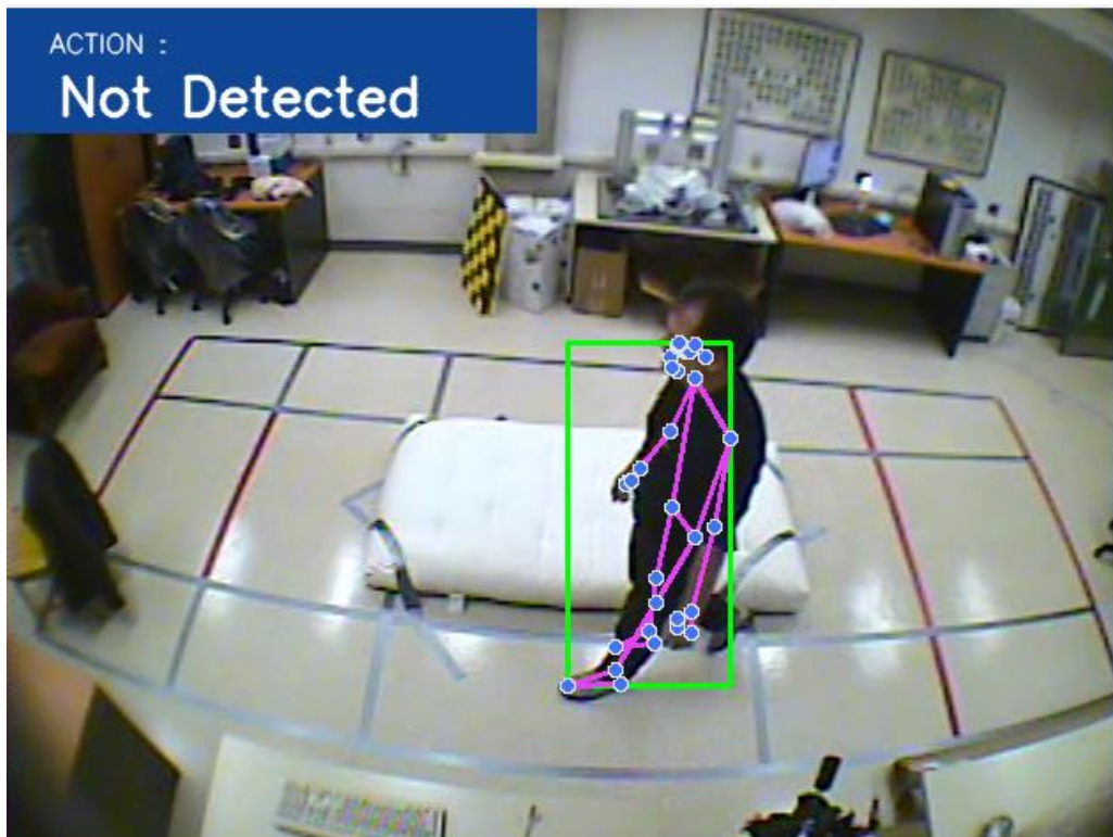
ภาพประกอบ 4 การตรวจจับการล้มด้วยอัตราส่วนของขอบเขตสี่เหลี่ยมรอบร่างกายมนุษย์ (Bounding box)
