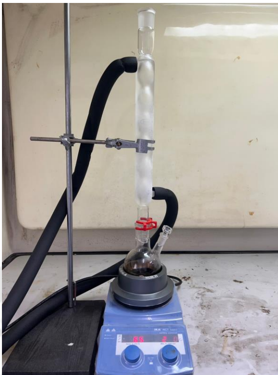
ภาพประกอบ 12 กระบวนการสังเคราะห์กาวลิกนินฟีนอลฟอร์มัลดีไฮด์
