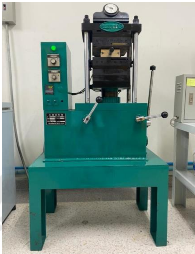
ภาพประกอบ 15 การขึ้นรูปปาร์ติเกิลบอร์ดขดระมัดร้อน
