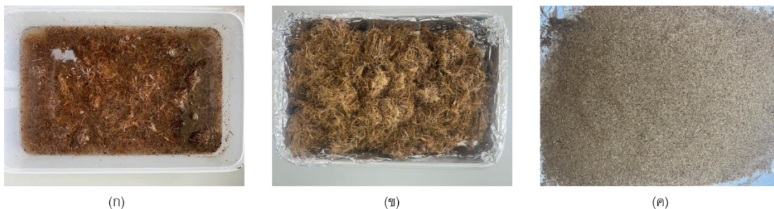
ภาพประกอบ 13 ขั้นตอนการเตรียมเส้นใยเปลือกผลปาล์ม ก) เส้นใยขณะแช่น้ำ, ข) เส้นใยหลังอบที่ 80 องศาเซลเซียส, ค) เส้นใยหลังตัดขนาดน้อยกว่า 1 เซนติเมตร
