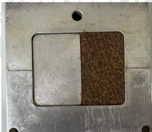
ภาพประกอบ 14 แสดงการนำส่วนผสมบรรจุลงแม่พิมพ์
