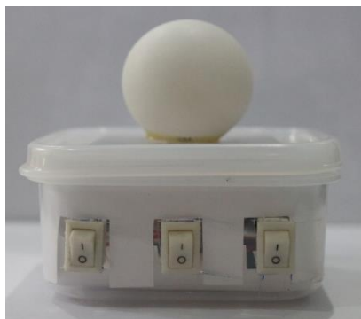
ภาพประกอบ 33 ชุดทดลองเรื่องการผสมแสงสีที่มีลูกปิงปองเป็นฉากรับแสง
