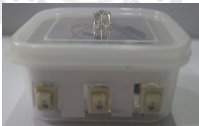
ภาพประกอบ 25 กล่องพลาสติก พร้อมติดตั้งหลอด LED บนฝากล่อง
