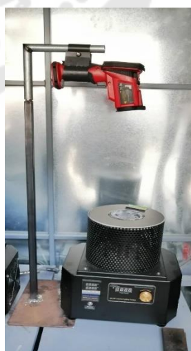
ภาพประกอบ 50 การติดตั้งการวัดอุณหภูมิของเทอร์โมคัปเปิล (Thermocouple) ในการเทียบกับอินฟราเรดเทอร์โมมิเตอร์ (Infrared Thermometer)
