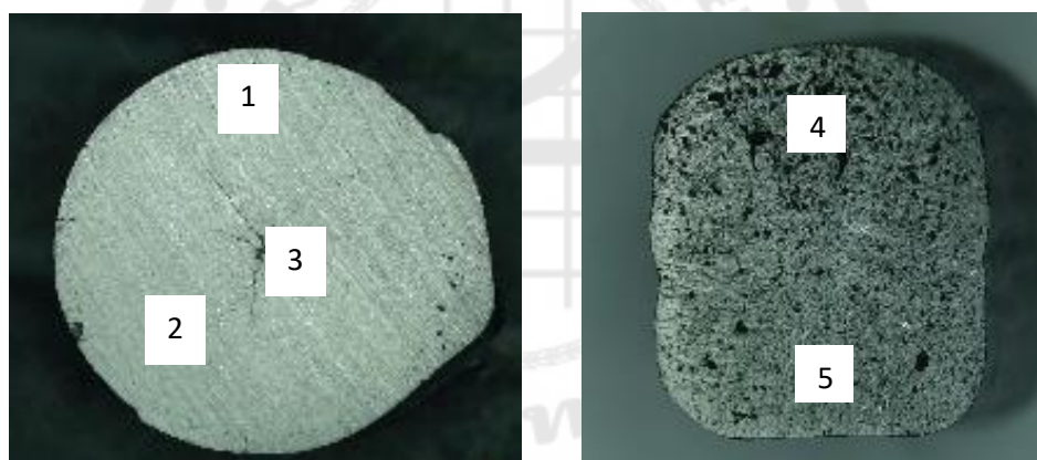
ภาพประกอบ 63 บริเวณที่ทำการตรวจสอบองค์ประกอบทางเคมีด้วยเทคนิค EDS โดยระบุตำแหน่งในการตรวจวัด
