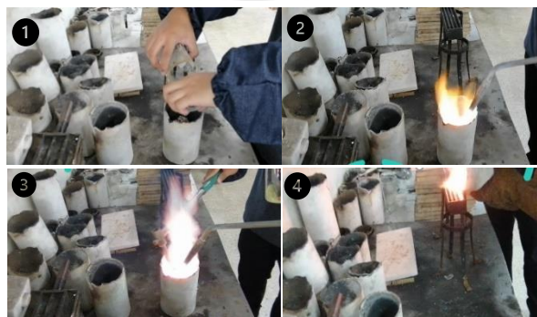
ภาพประกอบ 42 แสดงขั้นตอนการหลอมแท่งยาถมดำด้วยกระบวนการหลอมมือ
