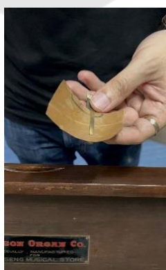
ภาพประกอบ 17 ภาพการสอดกระดาดเข้าทราบายไปเพื่อตั้งเสียง ที่มาภาพ นายศุภกาญจน์ พิมพิสาร
