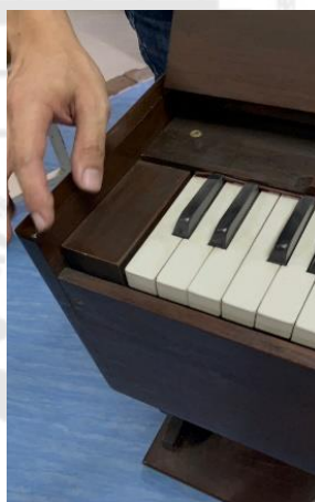
ภาพประกอบ 14 ภาพลิ้นซ้ายสุดของออร์แกนที่จะถูกร่นออกไป ที่มาภาพ นายศุภกาญจน์ พิมพิสาร
