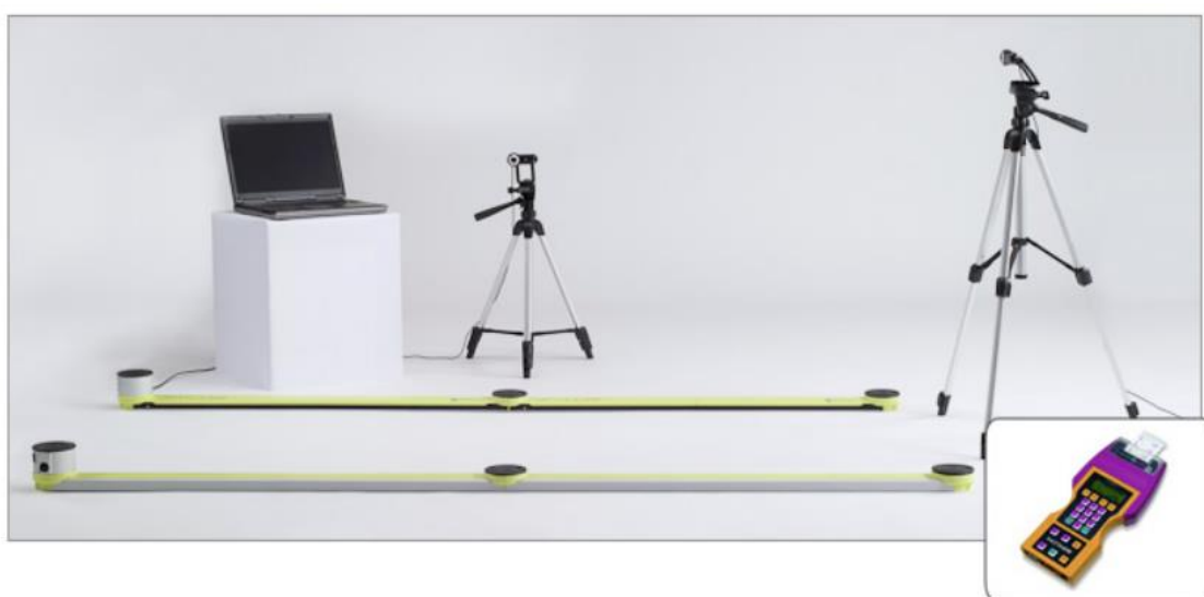
ภาพประกอบ 2 เครื่องมือที่ใช้วัดการเร่งความเร็ว ความยาวก้าว และจำนวนการก้าว
