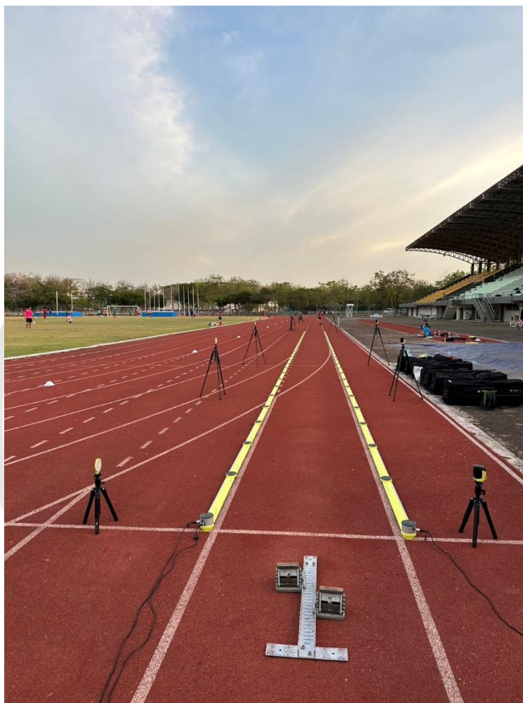
ภาพประกอบ 7 เครื่องมือที่ใช้วัดความเร็ว
