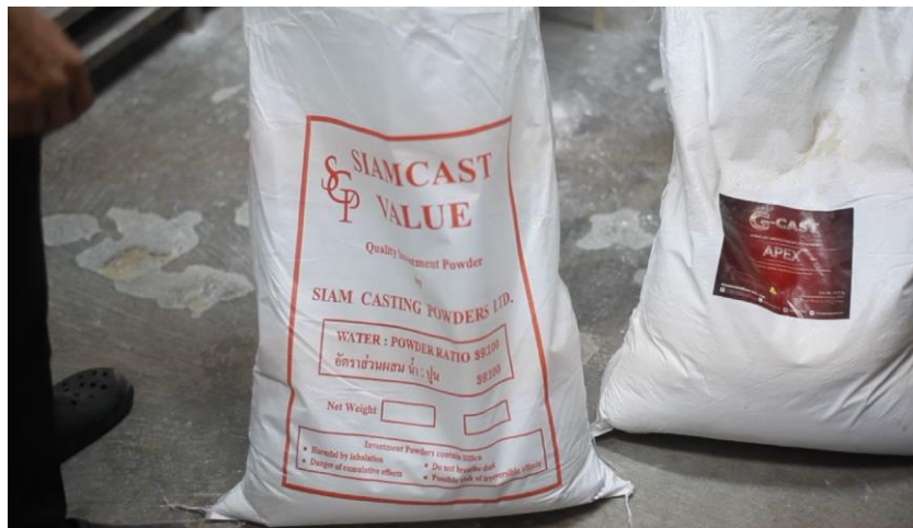
ภาพประกอบ 62 ปูนที่ใช้ในการหล่อเพชรซี่กครั้งนี้เป็นปูนละเอียดพิเศษ ปูนหล่อแบบหรือปูน แวกซ์ สูตร 40:100
