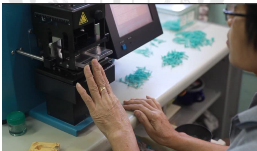
ภาพประกอบ 53 ขั้นตอนการฉีดเทียนด้วยเครื่องมือที่คำนวณอย่างแม่นยำ
