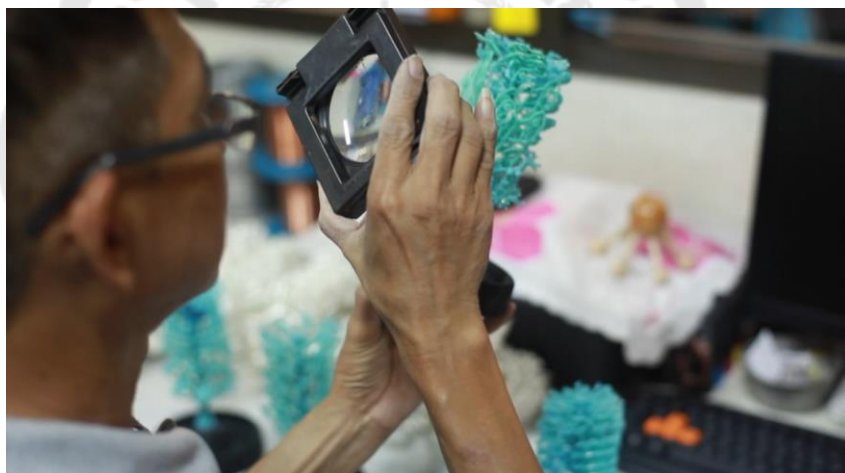
ภาพประกอบ 61 ตรวจเช็คความละเอียดของต้นเทียน และการติดเพชร ก่อนจะนำไปเข้าเตา เทปูน
