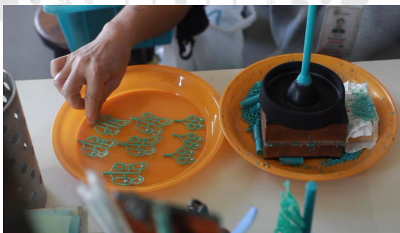
ภาพประกอบ 57 จากน้ำนำเทียนที่ได้จัดเรียงไว้มาติดบนดินเทียนเข้าหล่อ
