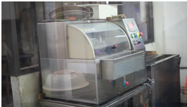
ภาพประกอบ 73 นำชิ้นงานไปเข้าเครื่องตัด ด้านในเครื่องตัดเป็นผงเหล็กตัดลักษณะเป็นเส้นโลหะ บางๆเหมือนเส้นขน ถูกปั่นละกลิ้งเพื่อตัดชิ้นงานให้เงาวาว
