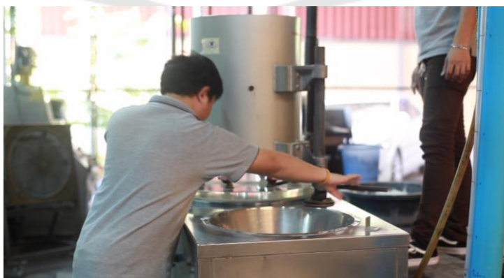
ภาพประกอบ 68 นำกระบอกตันเทียนที่เตรียมแล้วเรียงร้อยเข้าเครื่องอัดสูญญากาศ
