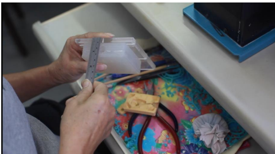
ภาพประกอบ 52 วัดขนาดบล็อกยาง พมพ์ยางเพื่อคำนวณแรงอัดฉีดเทียน
