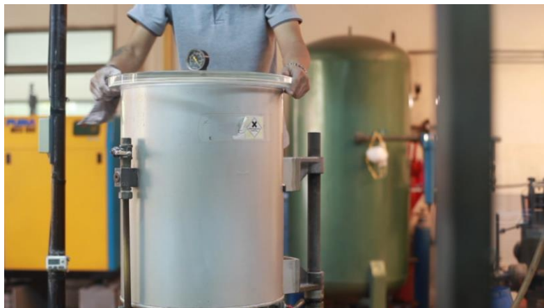
ภาพประกอบ 69 นำกระบอกล้างที่เตรียมแล้วเรียบร้อยเข้าเครื่องอัดสุญญากาศ
