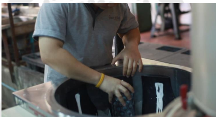
ภาพประกอบ 67 นำกระบอกตันเทียนที่เตรียมแล้วเรียงร้อยเข้าเครื่องอัดสูญญากาศ
