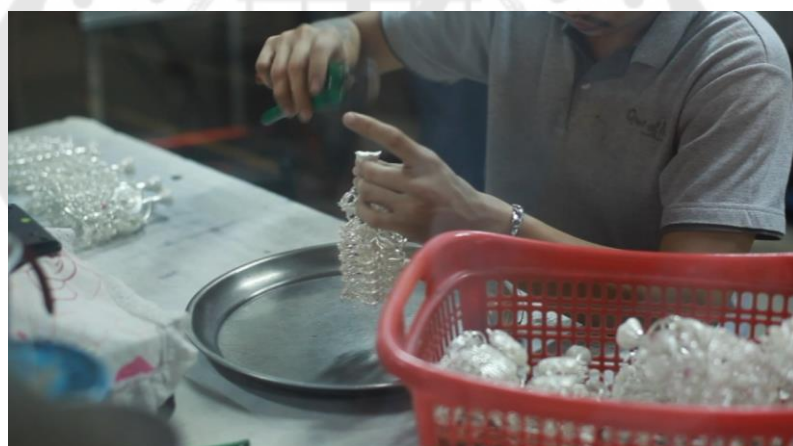
ภาพประกอบ 72 นำต้นชิ้นงานหล่อที่ได้มาติดชิ้นงานออกจากต้น และคำนวณน้ำหนักเนื้อโลหะ
