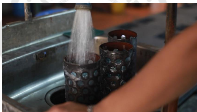
ภาพประกอบ 65 ฉีดล้างน้ำ กระบอกหล่อชิ้นงานครอบต้นเทียนเรียบร้อย
