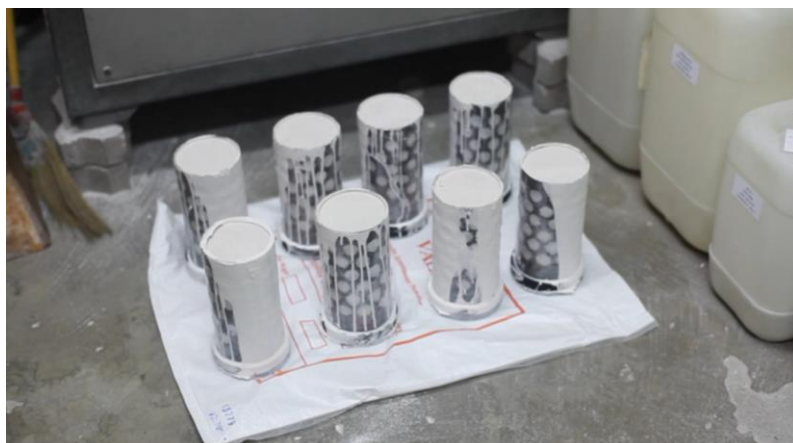
ภาพประกอบ 71 นำกระบอกที่เทปูนเสร็จเรียบร้อยแล้วมาปักไว้เพื่อรอเข้าตู้อบปูน เพื่อให้ด้านในแห้งสนิททั้งกระบอกหลังจากนั้นเข้ากระบวนการหล่อชิ้นงาน
