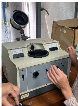
ภาพประกอบ 6 เครื่องมือฉาบผิวตัวอย่างด้วยโลหะหนัก (Sputter Coater)
