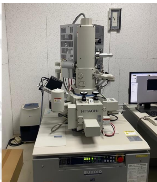
ภาพประกอบ 5 กล้องจุลทรรศน์อิเล็กตรอน SEM and EDX Scanning Electron Microscope (SEM) Energy Dispersive X-ray Spectrometer (EDX)
