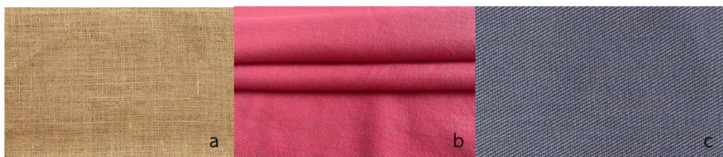
ภาพประกอบ 13 ผ้าที่นำมาใช้ในการวิเคราะห์ a) ผ้าฝ้าย b) ผ้าพอลิเอสเตอร์ c) ผ้าโพลีเอสเตอร์
