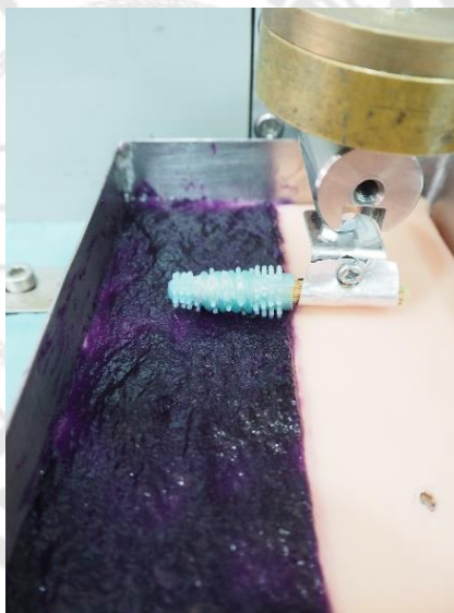
ภาพประกอบ 14 แสดงการติดตั้งหัวแปร่งและตุ่มน้ำหนัก 250 นิวตันเข้ากับเครื่องแปร่งฟัน V.P.2000
