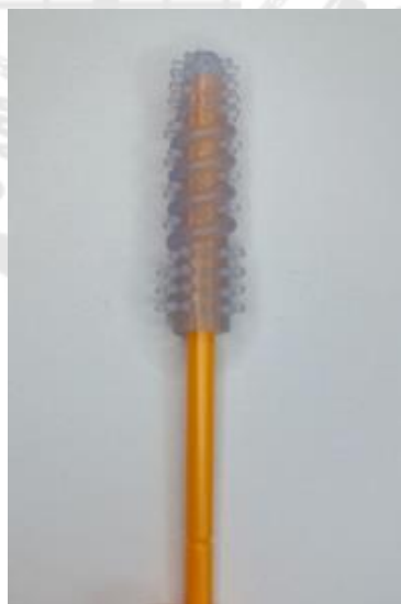
ภาพประกอบ 32 แสดงอุปกรณ์ทำความสะอาดช่องปากต้นแบบฯ ออกแบบครั้งที่ 1
