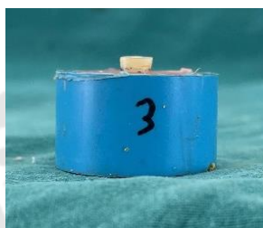
ภาพประกอบ 12 ตัวอย่างชิ้นงานบล็อคเรซินอะคริลิก
