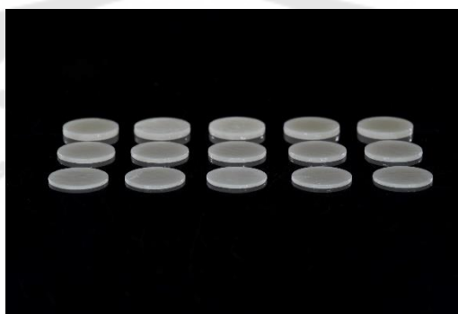
ภาพประกอบ 16 แสดงชิ้นตัวอย่างเซรามิกลิเทียมไดซิติลเกิดความโปร่งแสงสูงรูปทรงแผ่นกลม
