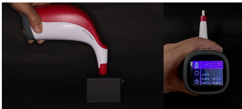
ภาพประกอบ 21 แสดงการวัดค่าความโปร่งแสงด้วยเครื่องสเปคโตรโฟโตมิเตอร์รุ่น
