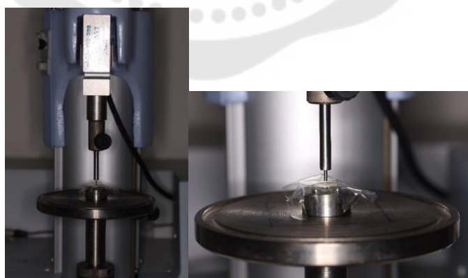
ภาพประกอบ 23 แสดงการทดสอบความแข็งแรงดัดขวางสองแกนด้วยเครื่องทดสอบสากลรุ่น EZ test
