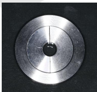
ภาพประกอบ 14 แสดงเบ้าหล่อโลหะ ประกอบด้วย เบ้าหล่อรูปครึ่งวงกลมและตัวครอบ
