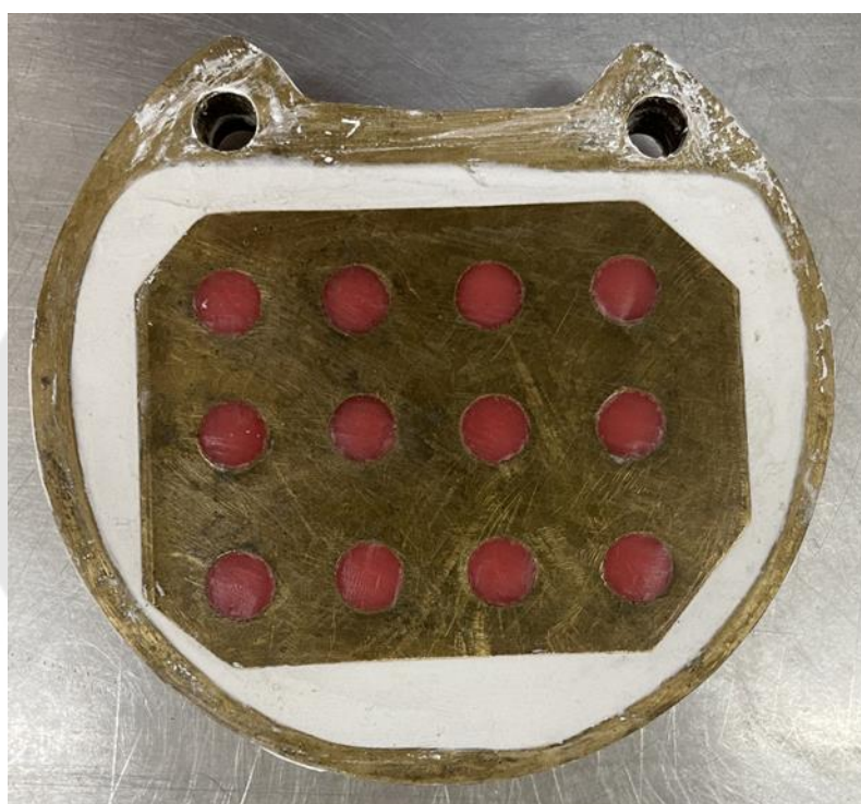
ภาพประกอบ 3 แสดงแม่พิมพ์แบบหล่อทองเหลือง
