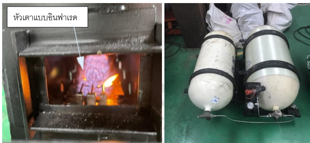
ภาพประกอบ 18 ชุดผลิตอากาศร้อนก๊าซไบโอมีเทนอัด (CBG)
