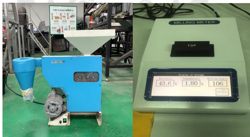
ภาพประกอบ 28 เครื่องกะเทาะเปลือกข้าวและเครื่องวัดสี วัดความโปร่งใสสีเมล็ดข้าว
