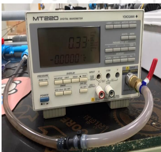
ภาพประกอบ 9 อุปกรณ์วัดการไหลแบบความดันตกคร่อม (Constant pressure drop flow meter) และผงอนุภาคนาโน \text{Fe}_3\text{O}_4 สำหรับการทดลอง
