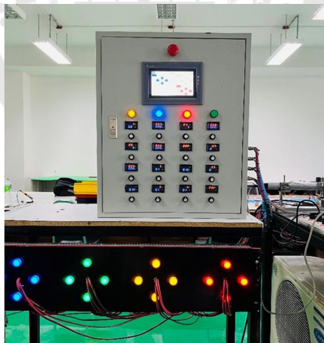
ภาพประกอบ 7 แสดงชุดควบคุมสนามแม่เหล็กไฟฟ้า
