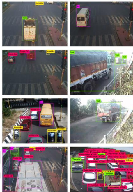
ภาพประกอบ 6 รูปภาพแสดงตัวอย่างผลการตรวจจับยานพาหนะที่ใช้หลักการ YOLO ในงานวิจัยของ Chauhan et al
