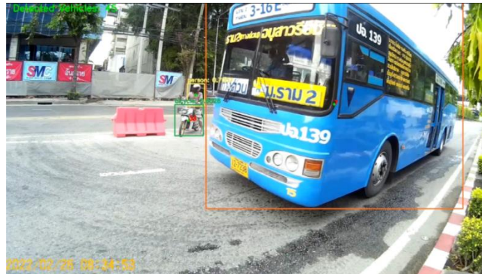
ภาพประกอบ 48 แสดงผลการนับจำนวนยานพาหนะโดยใช้ YOLO เป็นอัลกอริทึมในการตรวจจับ
