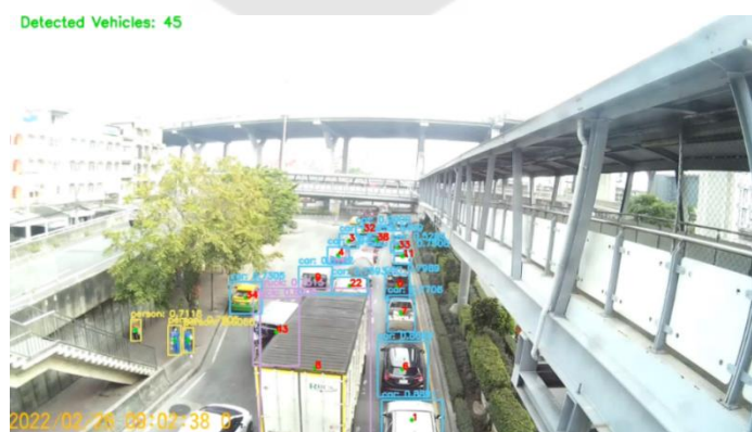
ภาพประกอบ 47 แสดงผลการนับจำนวนยานพาหนะโดยใช้ YOLO เป็นอัลกอริทึมในการตรวจจับ วัตถุ
