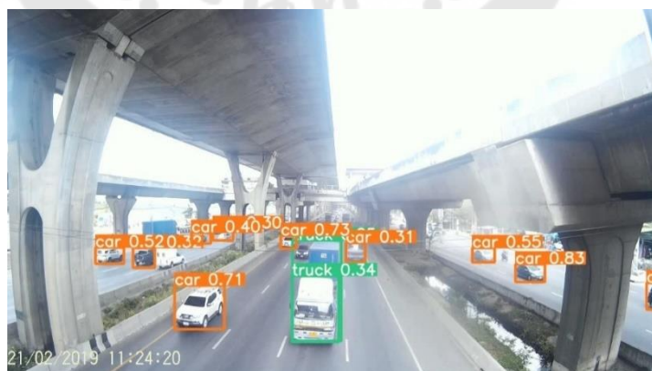
ภาพประกอบ 42 ผลการตรวจจับยานพาหนะจากการใช้ YOLOV8
