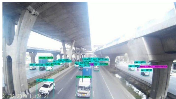
ภาพประกอบ 39 ผลการตรวจจับยานพาหนะจากการใช้ YOLOv4
