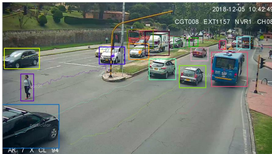
ภาพประกอบ 11 แสดงตัวอย่างผลการตรวจจับและติดตามยานพาหนะของงานวิจัยที่ถูกนำเสนอ ในงานวิจัยของ Forero & Calderon
