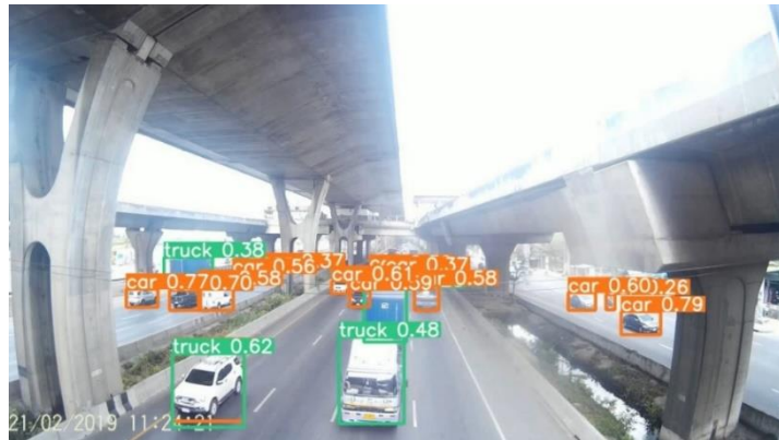
ภาพประกอบ 40 ผลการตรวจจับยานพาหนะจากการใช้ YOLOV5
