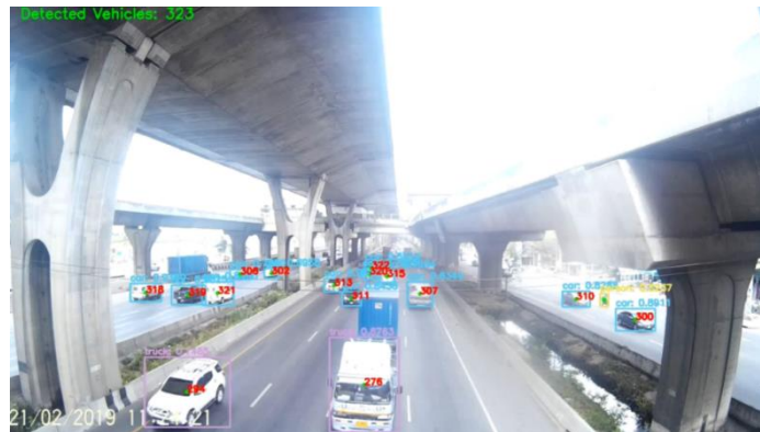
ภาพประกอบ 45 แสดงผลการนับจำนวนยานพาหนะโดยใช้ YOLO เป็นอัลกอริทึมในการตรวจจับ วัตถุ
