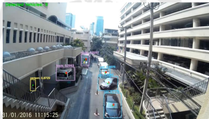
ภาพประกอบ 46 แสดงผลการนับจำนวนยานพาหนะโดยใช้ YOLO เป็นอัลกอริทึมในการตรวจจับ วัตถุ
