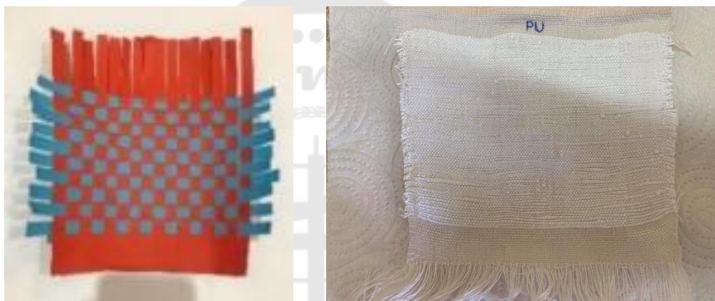
ภาพประกอบ 23 ตัวอย่างเส้นใยที่นำมาทอด้วยเครื่องทอแบบ 4 ตะกอโดยใช้ด้ายยืน 1 เส้น ด้ายพุ่ง 1 เส้น สอดขัดแบบขึ้นหนึ่งลงหนึ่ง
