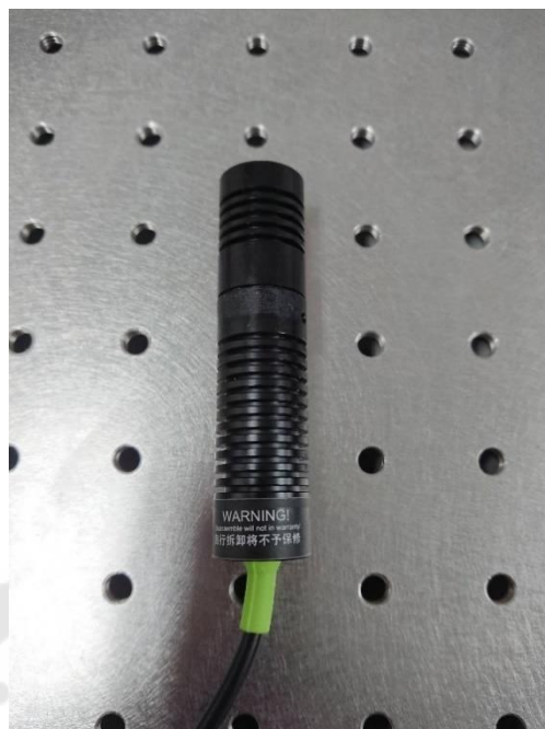
ภาพประกอบ 7 เลเซอร์สีเขียว ความยาวคลื่น 532.15 nm 100 mw
