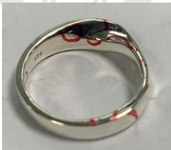
ภาพประกอบ 45 แสดง defect ตามดบนผิวชิ้นงาน
