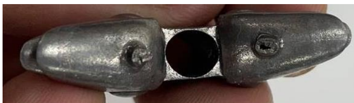
ภาพประกอบ 46 แสดง defect ผุบนผิวชิ้นงาน
