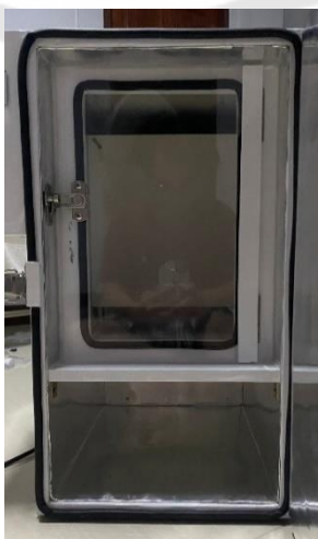
ภาพประกอบ 44 ส่วนด้านบนและด้านล่างของเครื่องบ่มเพาะเลี้ยงเซลล์
