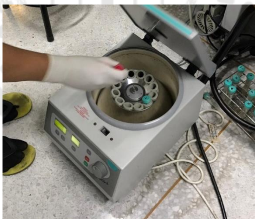
ภาพประกอบ 53 การปั่นเหวี่ยงเพื่อแยกตกตะกอนเซลล์
