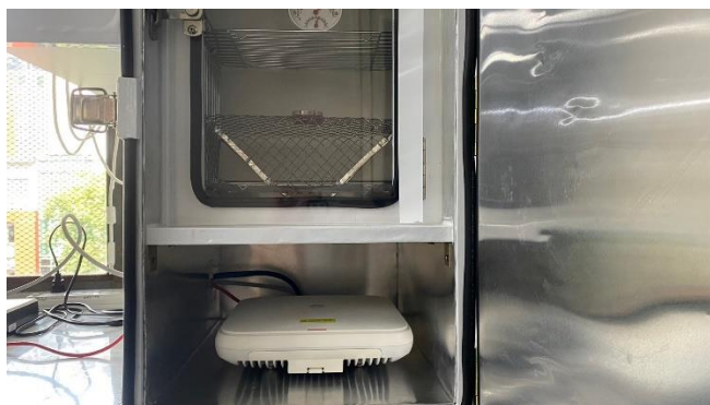
ภาพประกอบ 43 ชิ้นงานจริงส่วนที่ใช้เพาะเลี้ยงเซลล์และการติดตั้งตัวกระจายสัญญาณอินเทอร์เน็ตแบบไร้สาย
