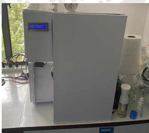
ภาพประกอบ 42 ชิ้นงานจริงส่วนที่ใช้เพาะเลี้ยงเซลล์และการติดตั้งตัวกระจายสัญญาณอินเทอร์เน็ตแบบไร้สาย
