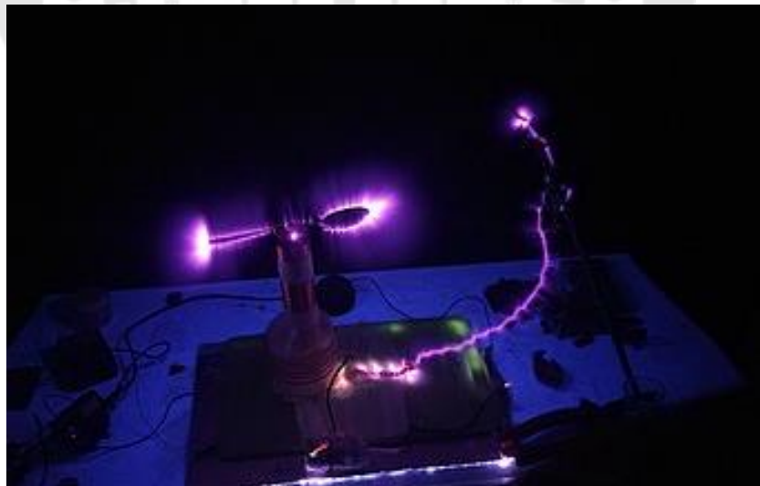
ภาพประกอบ 6 การปล่อยโคโรนาจากชั้นที่แนบมากับสถานีไฟฟ้าแรงสูงของ ขดลวดเทสลา
