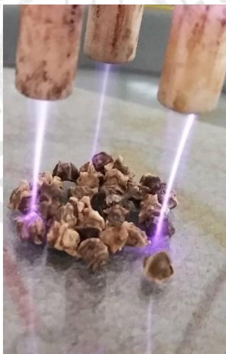
ภาพประกอบ 24 ชุดกำเนิดลำพลาสมาแบบ DBD jet สำหรับการปรับปรุงพื้นผิวเมล็ดปืทุท
