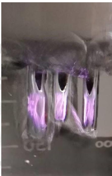
ภาพประกอบ 25 การกระตุ้นน้ำด้วยพลาสมาแบบโคโรนาเจ็ท (corona jet)
