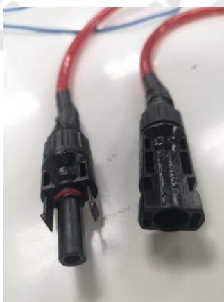
ภาพประกอบ 71 แสดงหัวต่อสายไฟ MC4 Connector
