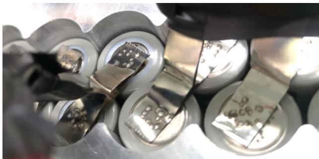
ภาพประกอบ 54 แสดงการเชื่อมต่อระหว่างแบตเตอรี่กับแผ่นนิกเกิล
