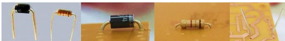
ภาพประกอบ 20 ตัวอย่างการประกอบชิ้นส่วนอิเล็กทรอนิกส์ลงบน PCB
