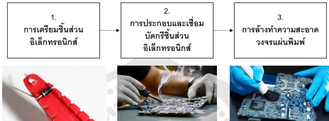
ภาพประกอบ 18 กระบวนการประกอบและเชื่อมบัดกรีวงจรแผ่นพิมพ์ด้วยมือ
