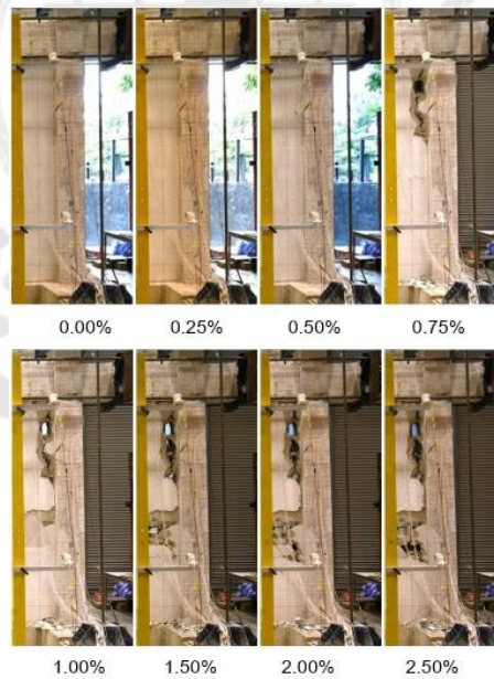
ภาพประกอบ 14 การวิบัติของตัวอย่างทดสอบที่ 2
