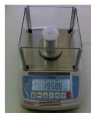
เครื่องชั่งน้ำหนัก ความละเอียด 0.001 กรัม
