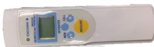
ภาพประกอบ 23 เครื่องวัดอุณหภูมิ Yokogawa Emission Thermometer 530
