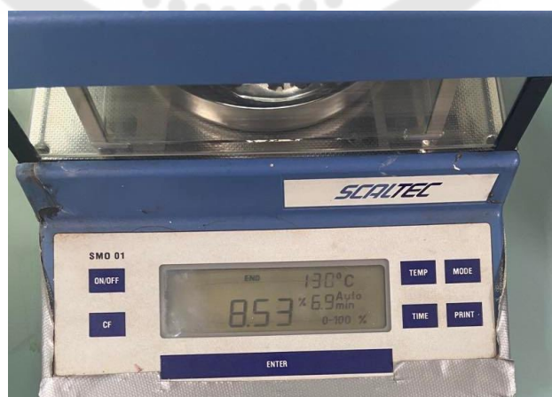
ภาพประกอบ 32 ผลการวิเคราะห์ความชื้นของเครื่องวิเคราะห์ความชื้นเมื่อเสร็จสิ้นกระบวนการ
