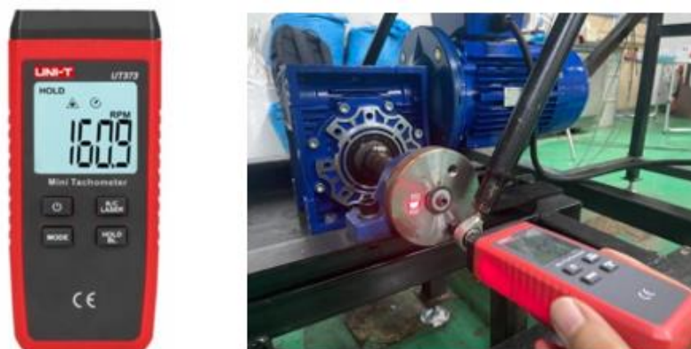
ภาพประกอบ 28 เครื่องวัดความเร็วรอบ และตำแหน่งวัดความเร็วรอบในการยกห้องอบแห้ง
