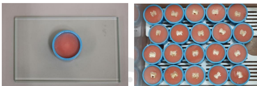
ภาพประกอบ 14 แสดงการยัดชิ้นงานลงแบบหล่อท่อพีวีซี (PVC) ด้วยอะคลิลิกชนิดบ่มตัวโดยไม่ใช้ความร้อน
