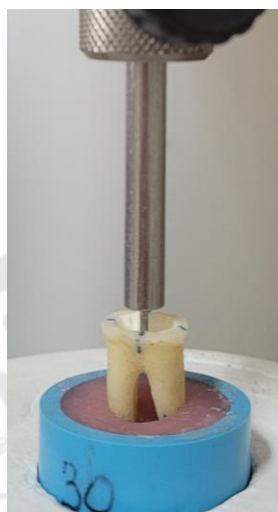
ภาพประกอบ 9 การทดสอบความแข็งแรงพันธะผลัดออกโดยใช้เครื่องทดสอบสากล
