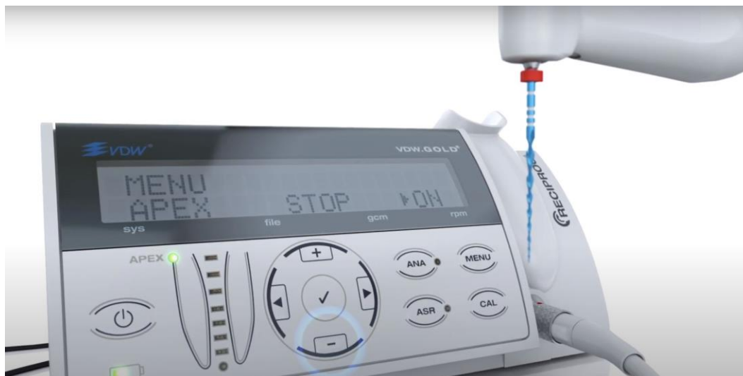
ภาพประกอบ 15 แสดงภาพจำลองของภาพหน้าจอเปิดโหมดหยุดหมุนปลายรากอัตโนมัติ (52)
