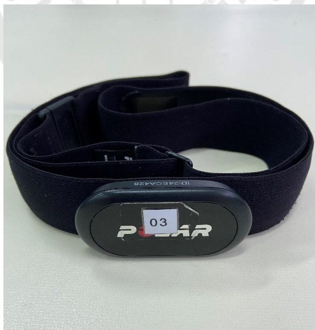
ภาพประกอบ 29 อุปกรณ์วัดอัตราการเต้นของหัวใจ (ยี่ห้อ Polar รุ่น H10)
