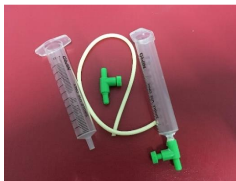
ภาพประกอบ 3 ตัวอย่างชุดไทเทรตกรด-เบส
