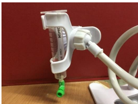
ภาพประกอบ 3 ตัวอย่างชุดไทเทรตกรด-เบส
