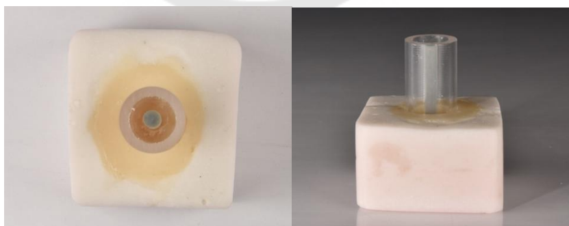
ภาพประกอบ 25 ท่ออะคริลิกใสและเดือยฟันไฟเบอร์บนแท่นสำหรับสร้างตัวอย่างทดลอง
