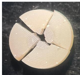
ภาพประกอบ 43 ความล้มเหลวที่พื้นผิวยึดติดประเภทที่ 1 (Cohesive failure ของเดือยฟันและวัสดุก่อแกนฟัน)
