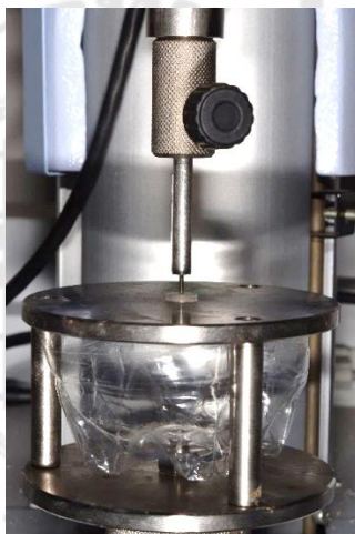
ภาพประกอบ 33 กดขึ้นทดสอบด้วยเครื่องทดสอบสากล
