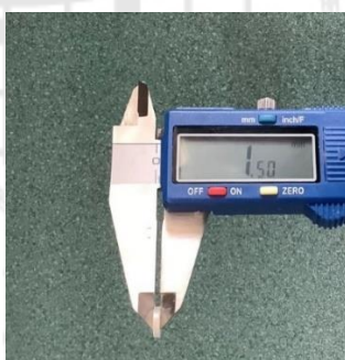
ภาพประกอบ 31 วัดความหนาของชั้นทดสอบด้วยดิจิตอลคาลิเปอร์
